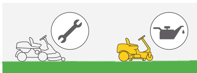
La plupart des coupes frontales ont un système de contrôle complexe basé sur des câbles Bowden, qui doivent être ajustés fréquemment. Les rayons de braquage zéro de Cub Cadet sont équipées d'une direction robuste en métal, qui ne nécessite qu'une petite lubrification toutes les 25 heures d'utilisation.
