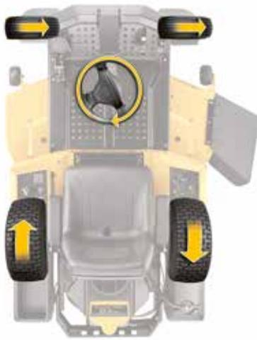
Ce système innovant permet, grâce au volant, de commander la direction des roues avant et la rotation des roues arrière. De plus, la double transmission permet un contrôle indépendant des roues arrière lors de la rotation à 360°. Un meilleur contrôle, une meilleure stabilité, pour de meilleurs résultats !
