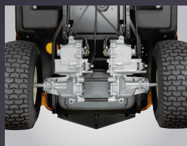
DOUBLE TRANSMISSION HYDROSTATIQUE
