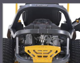
CHÂSSIS TUBULAIRE 50X50 MM
