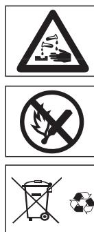
**Varning! Risk för frätskador genom kontakt med batterivätska.**
